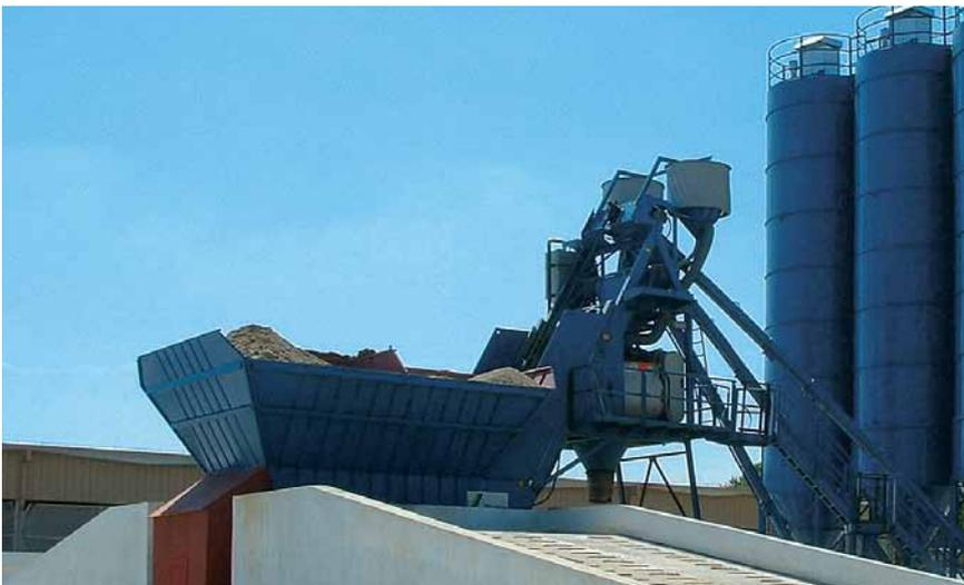
*El silo de compartimentos con cuatro cámaras puede ser llenado desde las rampas laterales. El alimentador llano funciona al mismo tiempo como depósito de pesaje.*
