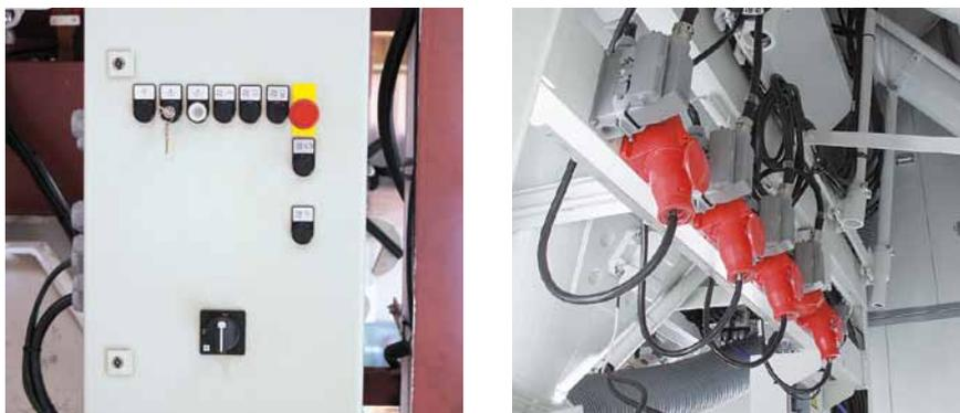
*Enchufes para montar y desmontar rápidamente la conexión eléctrica del conductor colectivo.*
