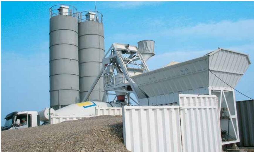
Los silos en serie son usados para almacenar grandes cantidades de reserva o más de cuatro tipos de áridos. Para pesar se utiliza una cinta, que descarga después los áridos en el cargador.
